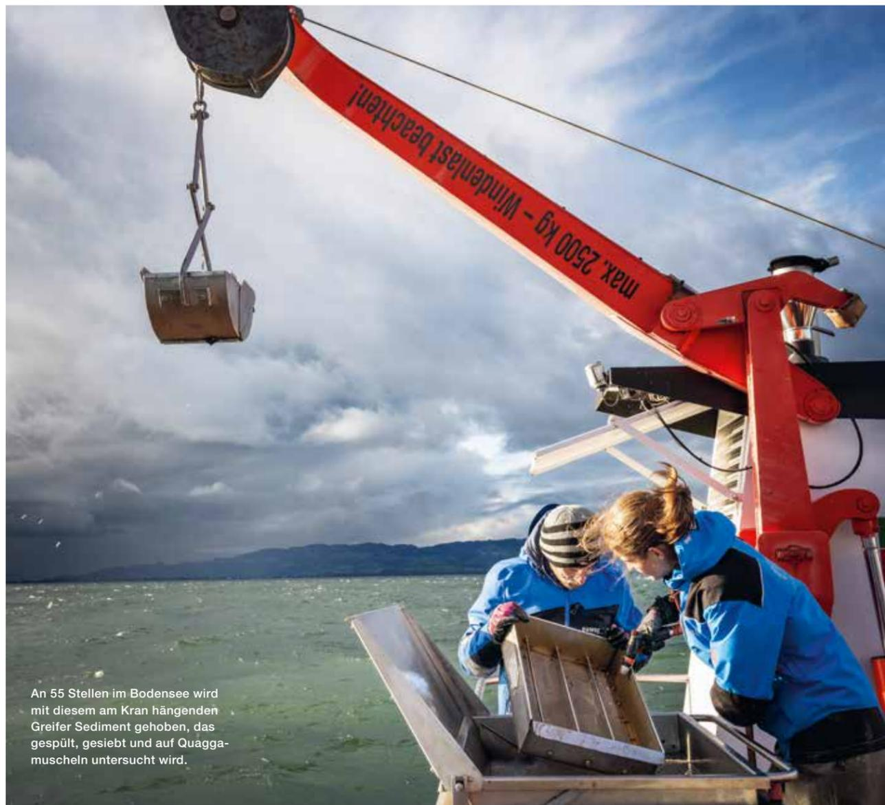
An 55 Stellen im Bodensee wird mit diesem am Kran hängenden Greifer Sediment gehoben, das gespült, gesiebt und auf Quagga-muscheln untersucht wird.
